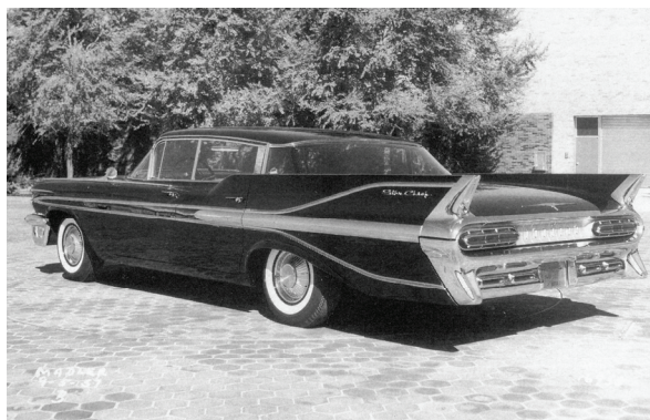
Ces ailerons, appelées "oreilles de lapin" par les dessinateurs chez Pontiac, ont longtemps fait parti des plans de Pontiac, mais finalement abandonnés car elles limitaient la vision arrière.
