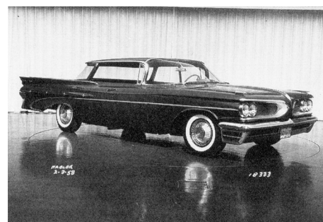
On remarque sur cette Pontiac 1959, modèle 4 portes à toit rigide, le toit allongé dépassant la lunette arrière.
