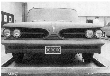
Sur ce modèle en argile daté 1957, on remarque la voie élargi [wide track] qui débute sur les modèles 1959.
