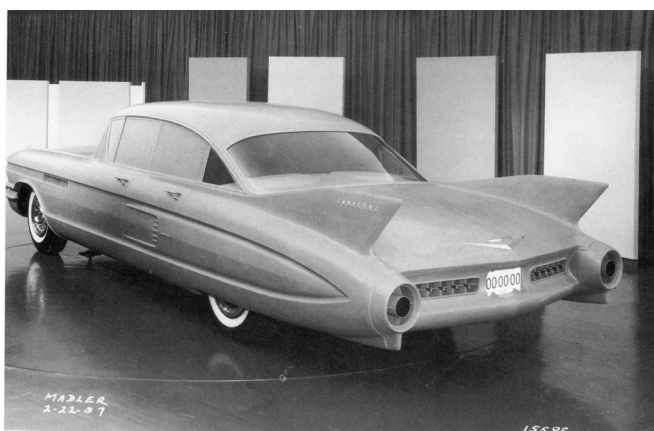
Cette proposition datée de 1957 pour la Cadillac 1959, incorporait dans le pare-choc arrière, une calandre à motif délicat. De plus remarqué les pots d'échappement de forme circulaire.
