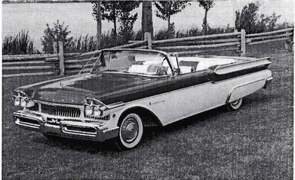
Cette Mercury est pourvue de l'option « **Turnpike Cruiser** », ce qui signifie qu'elle est propulsée par un moteur V8 de 368 p.c. emprunté à Lincoln livrant une puissance de 290 chevaux et avec transmission Ford-O-Matic à poussoirs.
