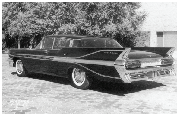
Ces ailerons, appelées "oreilles de lapin" par les dessinateurs chez Pontiac, ont longuement fait parti des plans de Pontiac, mais finalement abandonnés car elles limitaient la vision arrière.
