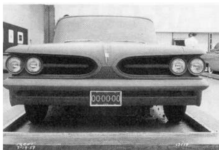
Sur ce modèle en argile daté 1957, on remarque la voie élargi [wide track] qui débute sur les modèles 1959.
